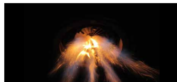
Το ακροφύσιο καυσίμου UHT Atomizer του John Zink, που παρουσιάζεται σε λειτουργία, μπορεί να κατασκευαστεί μόνο μέσω της προσθετικής μεθόδου 3D printing. (Φωτογραφία: Business Wire).
