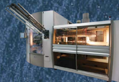
ΜΟΝΟΜΠΛΟΚ ΜΗΧΑΝΗΜΑ ΚΑΤΑΣΚΕΥΗΣ ΚΑΙ ΕΜΦΙΑΛΩΣΗΣ ΦΙΑΛΩΝ PET
