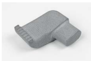
Κεφαλή οδοντιατρικού εργαλείου πριν την πυροσυσσωμάτωση
