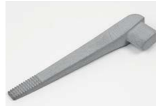
Κεφαλή εργαλείου συγκράτησης πριν την πυροσυσσωμάτωση
