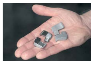
Κεφαλές οδοντιατρικού εργαλείου πριν την πυροσυσσωμάτωση
