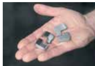
Κεφαλές οδοντιατρικού εργαλείου πριν την πυροσυσσωμάτωση
