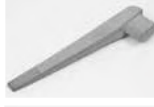
Κεφαλή εργαλείου συγκράτησης πριν την πυροσυσσωμάτωση
